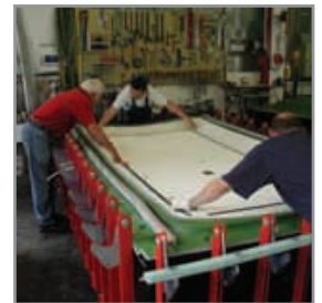
Die Form wird belegt - deutlich sichtbar die Metalleinlege-teile.
