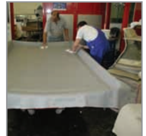
Fertiges Dach nach der Entformung.
