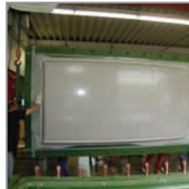
Fertiges Dach vor der Entformung.
